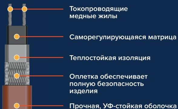
Эффект саморегулирования: повышение или понижение тепловыделения в ответ на изменение температуры окружающей среды
